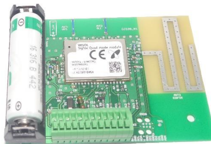
Vložená baterie v držáku
