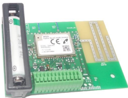
Zaklápění krytu držáku baterie s instalovanou baterií
